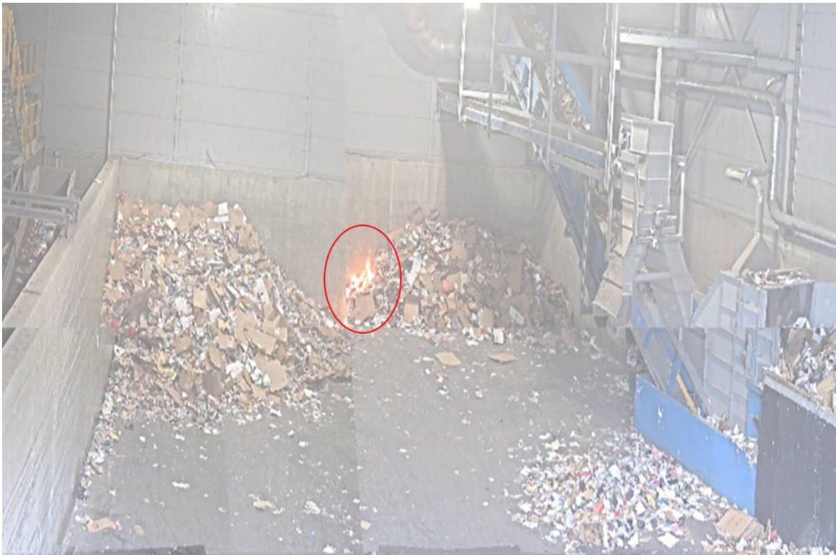
Figur 3-2. Kl. 09:30 var det synlige flammer fra papirhaugen. Bildet er sammensatt av flere bilder og hentet fra IR-kamera montert på vannkanonen.
